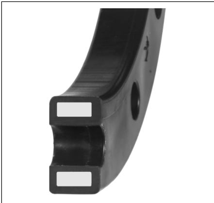
Die Schnittbilder zeigen die dickwandige (diffusionsdichte) Ummantelung und die Kernform mit hohem Widerstandsmoment.
