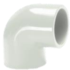
PVDF Winkel 90° mit Schweißmuffen, PN 16
